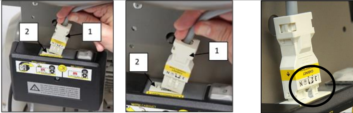
Abb. 13: Anschließen eines Kompressors mit Gehäuse
