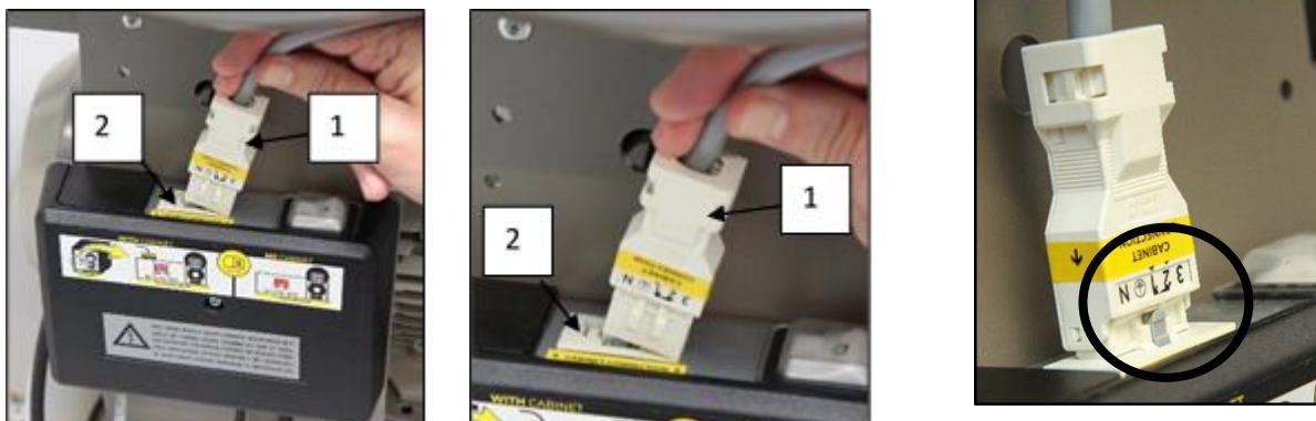
Obr. 13: Zapojenie skrinky ku kompresoru
